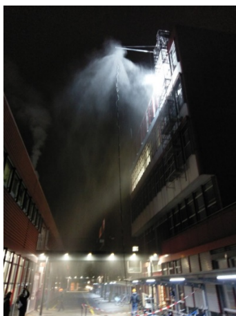
Abbildung 1 Düsentests auf dem Dach der HSLU und optische Messung (Laser) des Tropfenspektrums der neuen Düsen.
